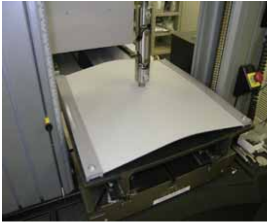
耐荷重試験状況
